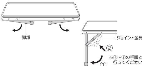
③それぞれの本体脚部にジョイントパイプをしっかりと差し込み確実にセットしてください。
