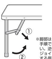
※脚部は、必ず①～②の手順で収納してください。逆の手順で行うと、ジョイント金具が変形する原因になります。
